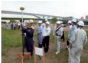
人工衛星を使用した測量
